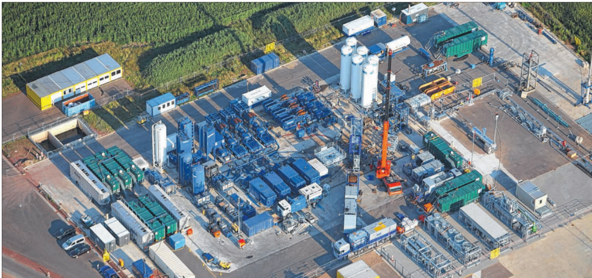
Ausrüstung zum „Hydraulic fracturing“ – Kurzform: Fracking – auf einem versiegelten Bohrplatz in Goldenstedt im Landkreis Vechta in Niedersachsen.
